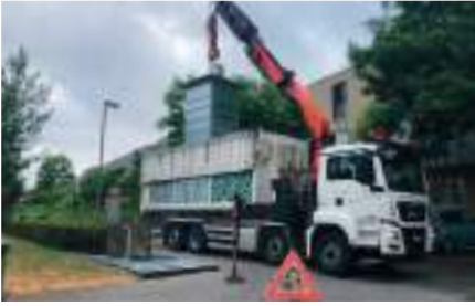
Hakenfahrzeug beim Leeren einer Hauskehricht-Sammelstelle
