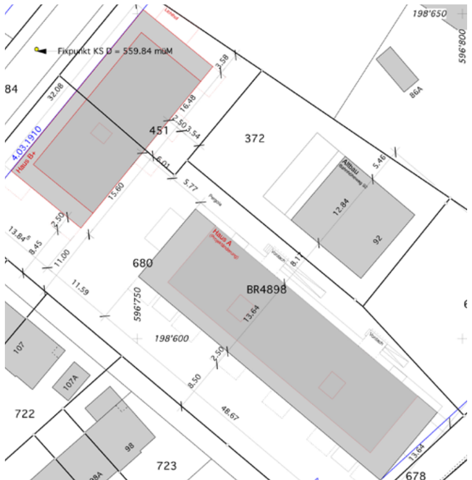
Katasterplan der optimierten Bebauung mit vergrössertem Haus B (BSR Bürgi Schärer Raaflaub Architekten AG)
